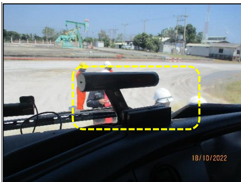
รูปที่ 2-12 รถบรรทุกน้ำมันซึ่งติดตั้งอุปกรณ์ระบุตำแหน่งด้วยดาวเทียม (GPS)
